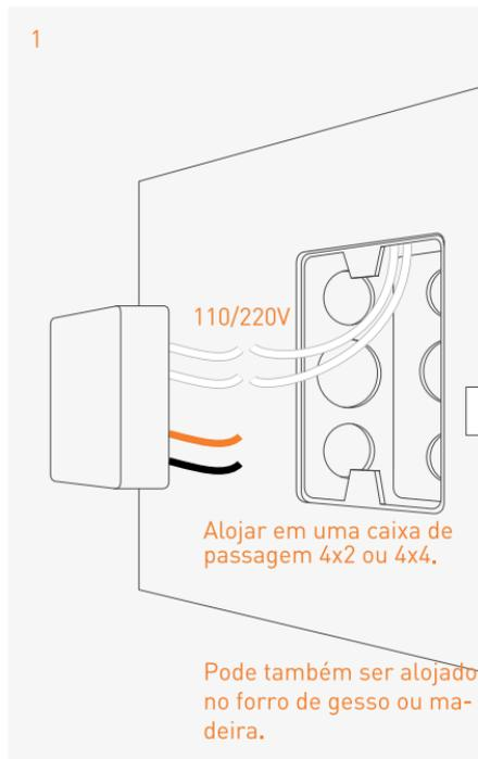
Conectar o **Driver Sygon Power DC** à rede elétrica (110/220V) pelos cabos BRANCOS, isolados através de fita auto-fusão ou conectores de torção.
